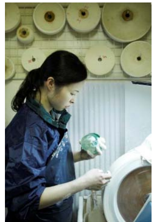
平成27年5月27日撮影 自宅ガラス工房にて 截金ガラスの最終仕上げの様子 フェルトを貼った回転盤に酸化セリウム 粉をつけてガラスを磨いている場面
