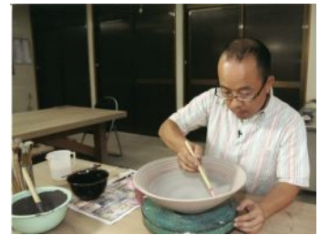
平成21年頃、素焼をした素地に緑釉を施釉しているところ
