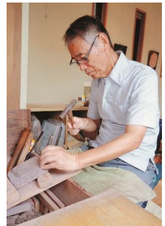
原石を硯の型にし、図案を書き、それに添って彫刻の部分を浮き立たせるように周りを金槌とタガネで落とす作業
